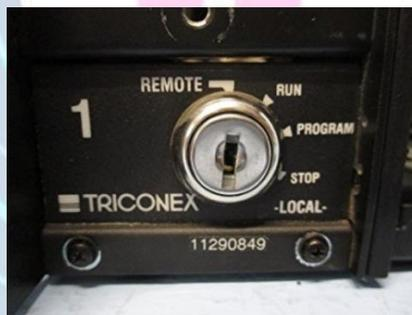
**Figura No. 1.** Triconex en estado “Program”, estado que facilita la ejecución del malware.
