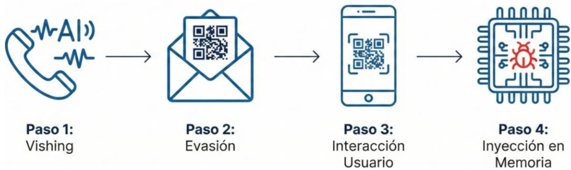
Figura 1: Cadena de infección híbrida. Diagrama de flujo que ilustra la secuencia de ataque, desde la ingeniería social por voz (Vishing) hasta la evasión de filtros mediante QR y la posterior inyección de código en memoria.
